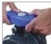
革新的なイージーフィットハンドルはバルブシステムに固定し組み合わされた中央のハブと簡単な操作でハブから取り外せるダブルスポークグリップで出来ています。また、ハンドルはボールシートキャリアの分解、エオンて及びサポート調節にもお使い頂けます。ハブからハンドルを取り外し、上部2つの突起物をシートキャリアの適切なスロットに締めたり緩めたりして入れ込んで下さい。
